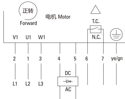
● 三相电机带过热保护器9根出线
