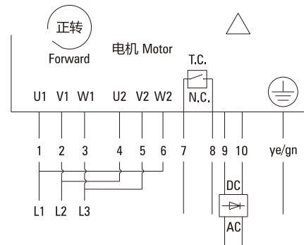
● 三相电机带电磁制动器11根出线
