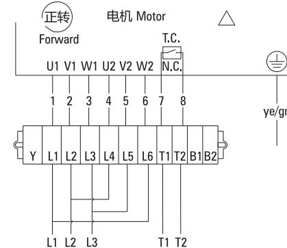
● 三相电机带电磁制动器带过热保护器11根引线
