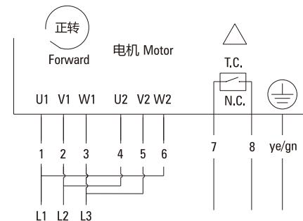
● 三相电机带电磁制动器带过热保护器11根出线
