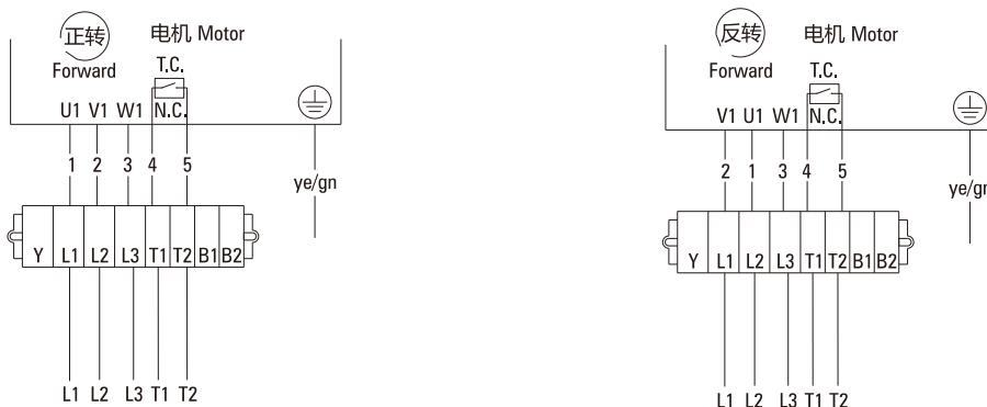
● 三相电机带电磁制动器带过热保护器8根引线
