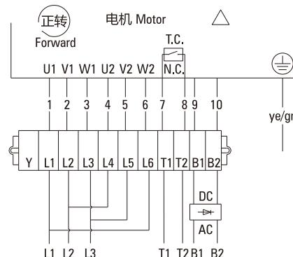
● 三相电机带过热保护器12根引线
