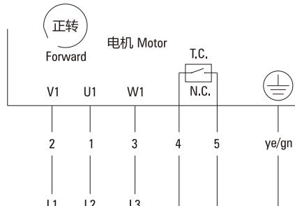
● 三相电机带电磁制动器带过热保护器8根出线
