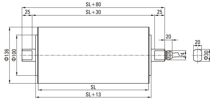
标准的滚筒长度和重量 Standard Drum Length And Weight:
