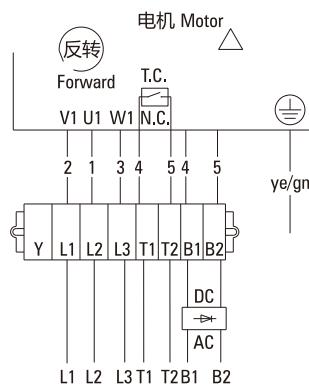
● 三相电机带过热保护器9根引线
